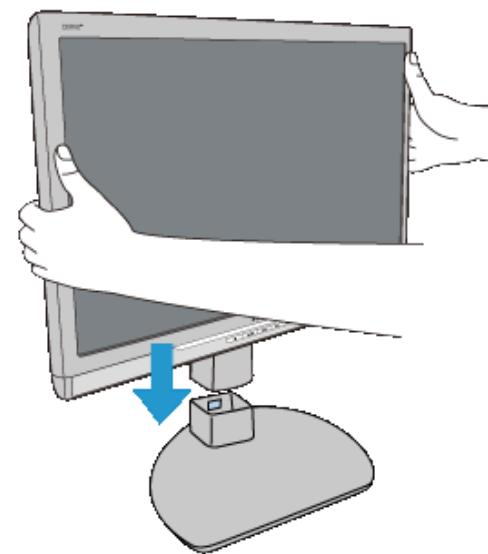
將顯示器底座接頭與顯示器底座連接至聽到喀嚓聲。
