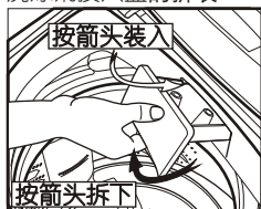
洗涤剂投入盒的拆装
