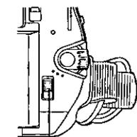
Al utilizar una MultiMediaCard (Tarjeta MultiMedia), debe usted ajustar el TAPE/M-CARD Switch (interruptor TAPE/M-CARD) a M-CARD.
