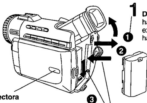
**1** Deslice el visor hacia atrás, hasta la posición de totalmente extendido, y luego inclínelo hacia arriba.
