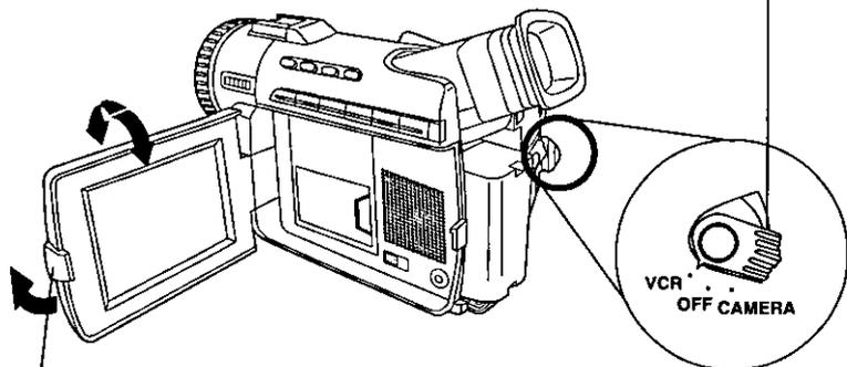
**2** Presione el botón de apertura del LCD (**LCD-OPEN**) para desbloquear el monitor LCD. Gírela hasta abrir completamente y ajusta el ángulo.
