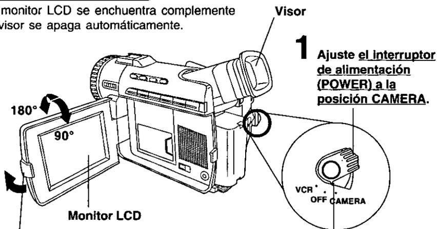
**2** Presione el botón de apertura del LCD (LCD-OPEN) para destrabar el monitor LCD. Gírela hasta abrir completamente y ajusta el ángulo.
