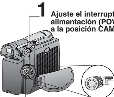
**1** Ajuste el interruptor de alimentación (POWER) a la posición CAMERA.
