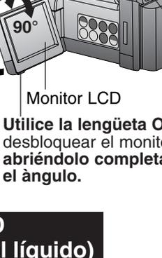
**2** Utilice la lengüeta OPEN para desbloquear el monitor LCD. Balancée abriéndolo completamente y ajuste el ángulo.
