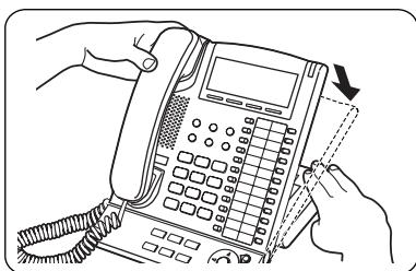
**2** 接上以太网电缆, 然后先安装墙壁固定转接器的①, 再安装墙壁固定转接器的②(附带)。
