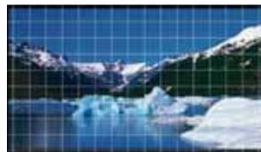
简单交叉影线功能可以进行重叠显示（固定间隔 50 点），以此检查摄像机的倾斜状况。可以将交叉影线功能赋予 3 个“功能”按键之一。
