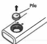
3. Inserte la pila nueva con el polo "+" mirando hacia arriba tal como se muestra en el diagrama.
