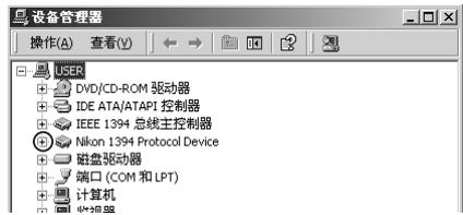
若“Nikon 1394 Protocol Device”未被列出，或者“Nikon D1X”（或“D1”、“D1H”）被列在“其他设备”下的话，请参照“重新安装设备驱动程序”（图 44）的指南，来重新安装设备驱动程序。
