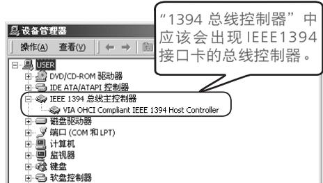
如果“设备管理器”中没有列出“IEEE 1394 总线控制器”，或是如果 IEEE 1394 接口卡以未知或其他设备显示，或前面出现红色或黄色的警告图标，请按照接口卡随附的手册中的说明，确定已正确安装驱动程序。
