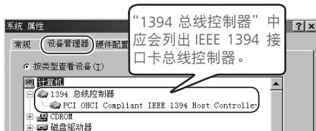
如果“设备管理器”中没有列出“IEEE 1394 总线控制器”，或是如果 IEEE 1394 接口卡以未知或其他设备表示，或者前面出现红色或黄色的警告图标，请按照接口卡随附的手册中的说明，确定已正确安装驱动程序。
