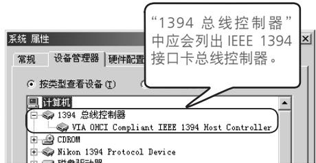
如果“设备管理器”中没有列出“IEEE 1394 总线控制器”，或是如果 IEEE 1394 接口卡以未知或其他设备表示，或者前面出现红色或黄色的警告图标，请按照接口卡随附的手册中的说明，确定已正确安装驱动程序。
