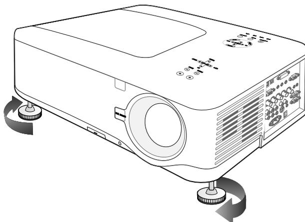
2. Per abbassare il livello del proiettore, sollevare il proiettore e girare i regolatori in senso antiorario.
