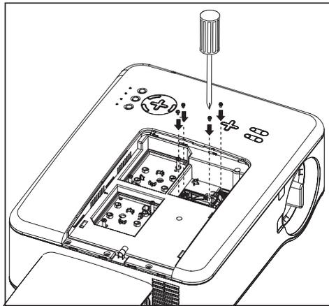
8. Rimettere il coperchio della ruota come indicato e fissare le viti del coperchio per bloccare il coperchio in posizione.
