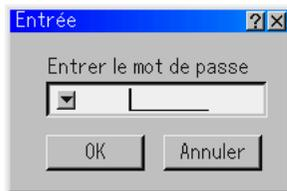
S'assurer que "▼" est mis en surbrillance et appuyer sur la touche ENTER. Le clavier logiciel apparaît. Utiliser le clavier logiciel pour taper un mot de passe et mettre "OK" sur l'écran de saisie "Enter le mot de passe" en surbrillance puis appuyer sur la touche ENTER. L'écran [Confirmer le mot de passe] s'affiche.
