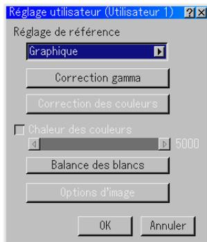
Lors de la sélection d'un des quatre préréglages ajustables par l'utilisateur (Utilisateur 1 à 4), le sous-menu suivant s'affiche. Chaque gamma ou couleur peut être personnalisée. Pour cela, sélectionner d'abord [Réglages] et appuyer sur la touche ENTER, et ensuite continuer avec les étapes suivantes.
