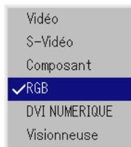
Appuyer sur la touche SOURCE du coffret du projecteur et la relâcher rapidement pour afficher la liste Source. Chaque fois que la touche SOURCE est enfoncée, la source d'entrée change comme suit: "Vidéo" (magnétoscope, appareil photo numérique ou lecteur de disque laser), "S-Video", "Composant" (lecteur DVD), "RGB", "DVI NUMERIQUE" (ordinateur) ou "Visionneuse" (diapos sur une carte PC) Appuyer sur la touche ENTER pour afficher la source sélectionnée.
