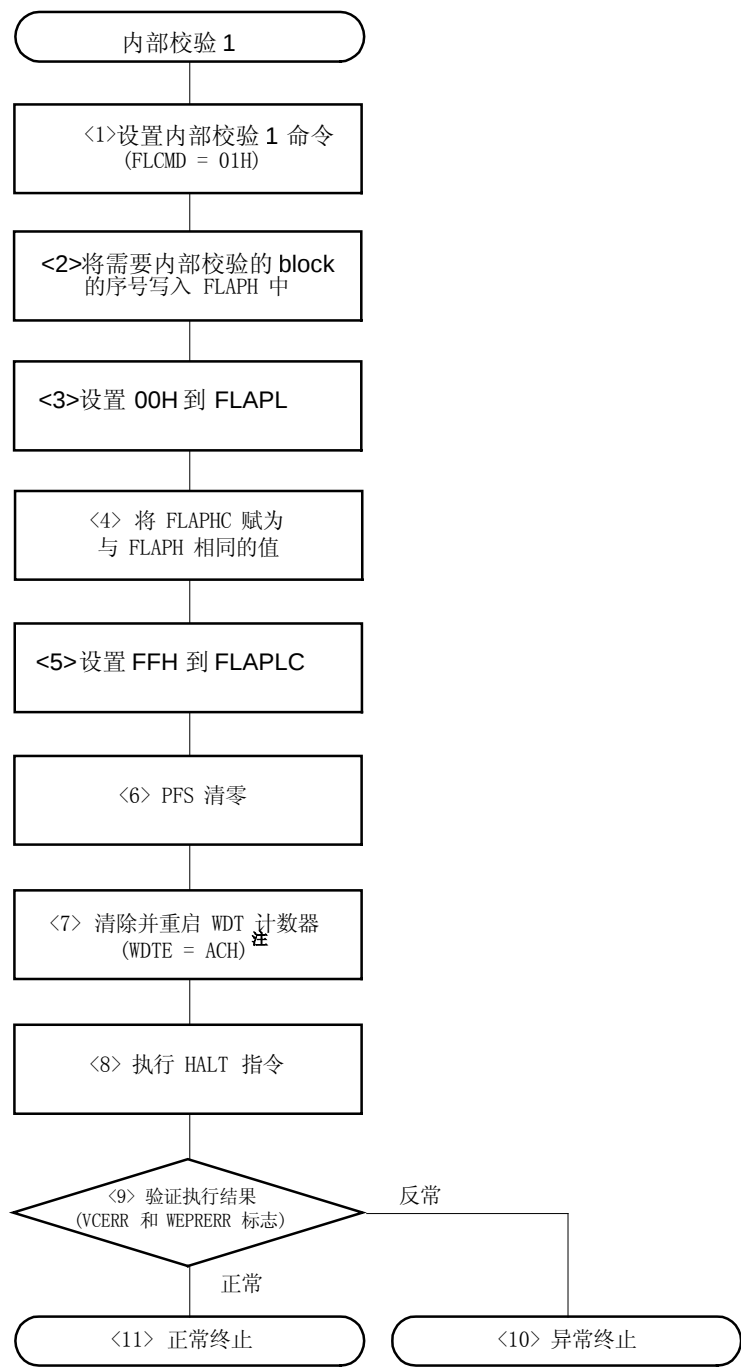
图 19-25. 自编程模式下内部校验 1 流程
