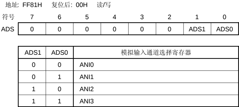
图 10-5. 模拟输入通道选择寄存器（ADS）的格式
