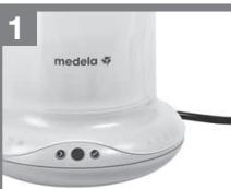
Zet de flessenwarmer op een vlakke, stabiele ondergrond. Sluit het netsnoer aan op de flessenwarmer en het stopcontact. Schakel het apparaat pas in nadat het water is bijgevuld en de flessen/potjes voeding zich in het apparaat bevinden.
