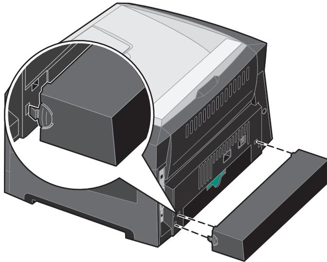
通过将盖板上的凸柱与打印机上的孔对齐，然后将盖板卡入到位来将防尘盖板（如果可用）连接到打印机的后部。
