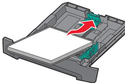
**注意：** 加载信签纸时使设计的打印面朝下。带有徽标的页面顶边应放在进纸匣的前部。
