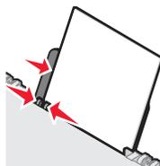
**注意：**为了避免发生卡纸，请确认调节进纸导轨时没有使纸张弯曲。
