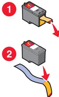
**警告：**请不要用手触摸打印墨盒后面的金色触点区域或打印墨盒底部的金属喷头区域。
