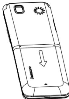
**警告：**拆卸电池之前一定要将手机关机并移去外部电源。绝对禁止在开机的情况下直接取出电池，否则可能损坏 SIM 卡和手机。
