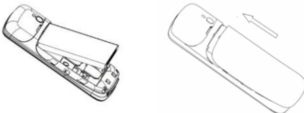
**警告：**拆卸电池之前一定要将手机关机并移去外部电源。绝对禁止在开机的情况下直接取出电池，否则可能损坏 SIM 卡和手机。
