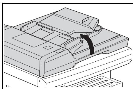
**注:** 请检查并确认无原稿留在原稿台或原稿出纸台上，然后再打开送稿器。打开送稿器时，放置在原稿台或者原稿出纸台上的原稿可能会掉落。
