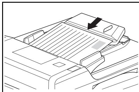
**重要事项：**放入的原稿高度不得高于粘贴于后部原稿宽度导板处的刻度线。放入原稿数量若超过容许量可能会导致原稿卡纸。（有关可放入原稿数量的信息，请参阅第 7-2 页送稿器可使用的原稿。）
