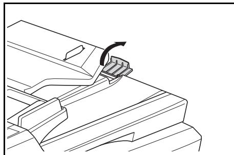
使用正面和背面原稿时，原稿将被翻转，因此原稿会暂时被排至出纸托盘。请勿在这段暂时排出期间内拿放原稿。若尝试用力将原稿拉出可能会造成原稿卡纸。
