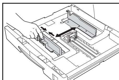
4 抓住长度尺寸调节片使纸张尺寸与长度导板相符合。
