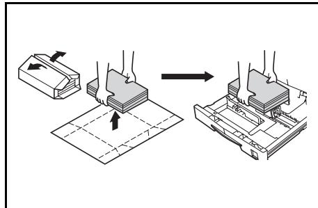
**重要事项：**当使用之前使用复印机复印的纸张时，请检查确保所有回形针和订书钉均已拿除。试图复印带有扣钉的纸张可能会导致图像不佳或操作故障。
