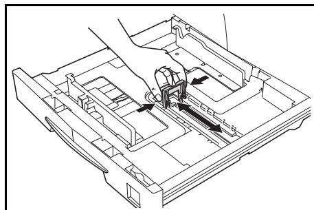
**重要事项：**针对 Ledger 纸张进行设定时，请如插图所示将长度尺寸调节片向右移到底，然后将其按下。
