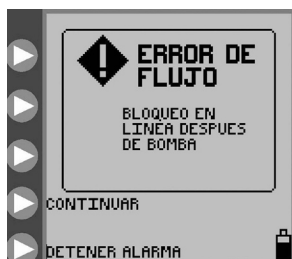
Figura 30. Pantalla de error de flujo.
