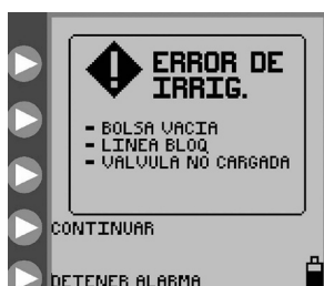
Figura 29. Pantalla de error de irrig.
