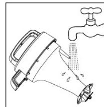
1. 机头：请用水轻轻洗去机头下部粘附的豆浆或其他东西，切勿将机头浸入水中，也不要用水清洗机头上部，以防止机头进水，发生短路现象。
