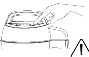
■ 制作豆浆前请确保机头如图所示放置到位，否则可能会造成断电不工作，粉碎效果不佳及喷溅问题。
