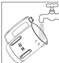
2. 杯体：请用清洁块仔细清洗杯体，将杯体底部以及侧面清洗干净，以免残留的豆浆产生异味。清洗时请勿将杯体浸入水中，请勿用水冲洗耦合器及底座，以防止杯体和底座进水引起的短路等安全问题。
