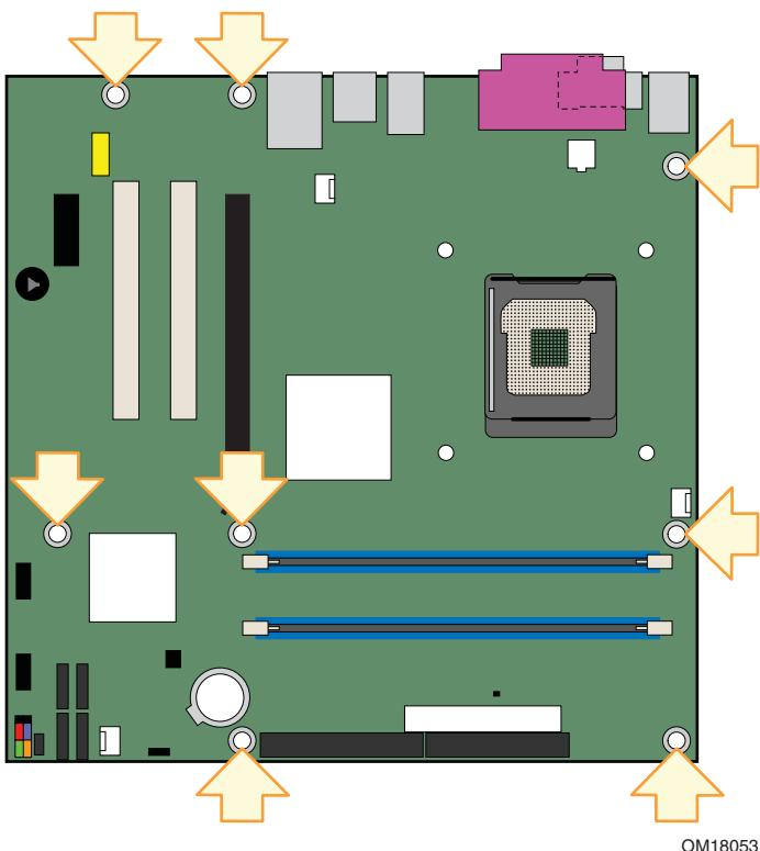
图 5. 台式机主板 D915PDT 安装螺丝孔位置
