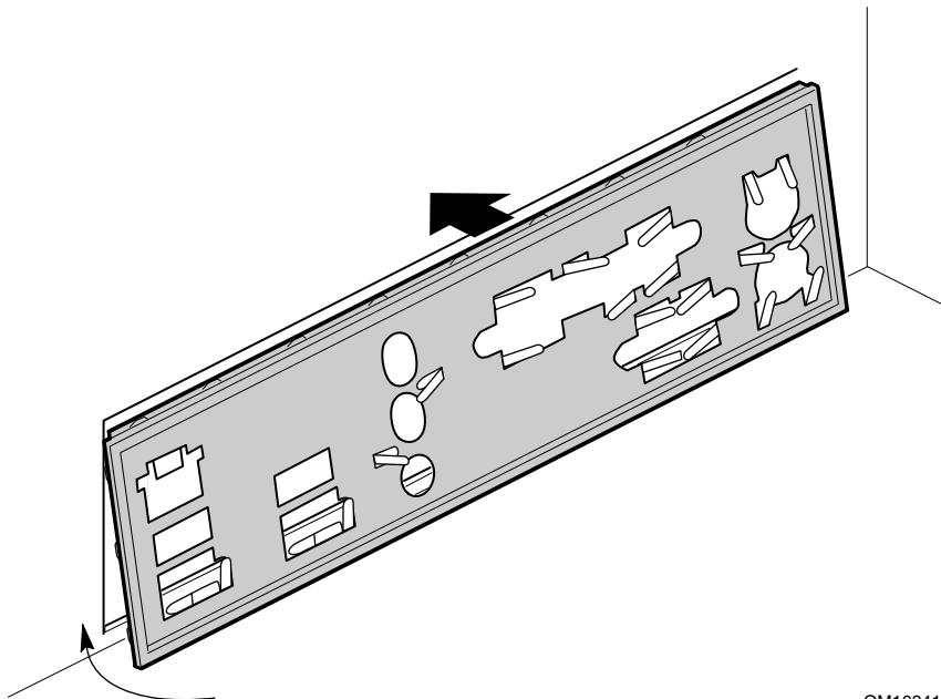
图 4. 安装 I/O 防护板
