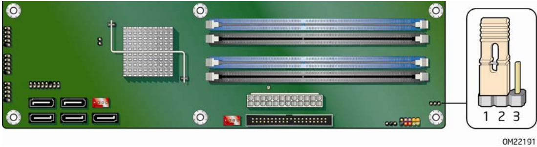
图 26. BIOS 配置跳线块位置
