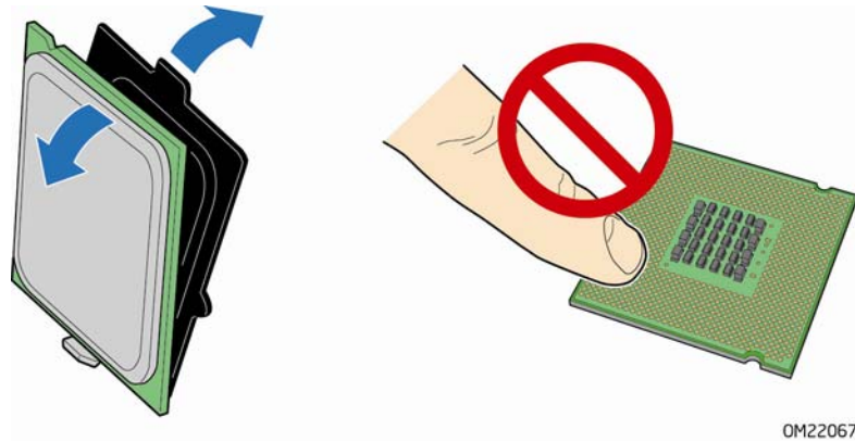
图 9. 从处理器保护罩中取出处理器
