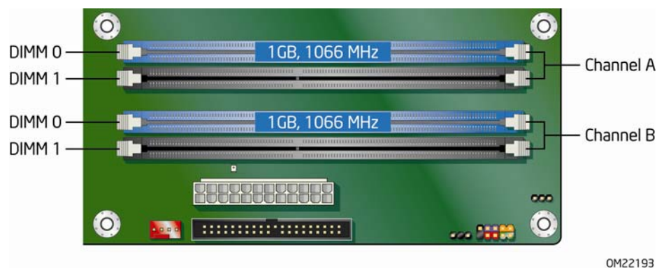
图 13. 两条 DIMM 下双通道内存配置
