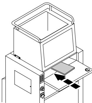
**D** Bei Zuführung von vorne, Start und Stopp automatisch.
