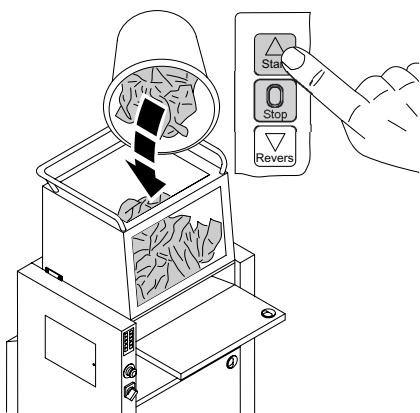
**D** Bei Zuführung von oben Start und Stopp manuell.
