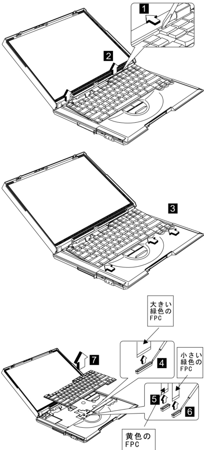
注: 挿入するときは、必ず FPC のフィンガー側が外を向くようにしてください。
