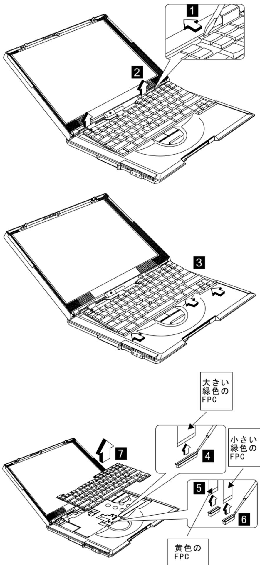
注: 挿入するときは、必ず FPC のフィンガー側が外を向くようにしてください。
