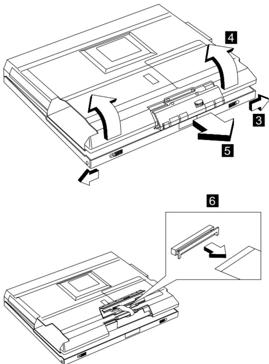
注: FPC は、もう一方の端がシステム・ボードに接続されています。CD プレーヤー・パネルおよび CD プレーヤー・コントロール・ボードを取り外すときは、FPC を注意しながらリリースしてください。
