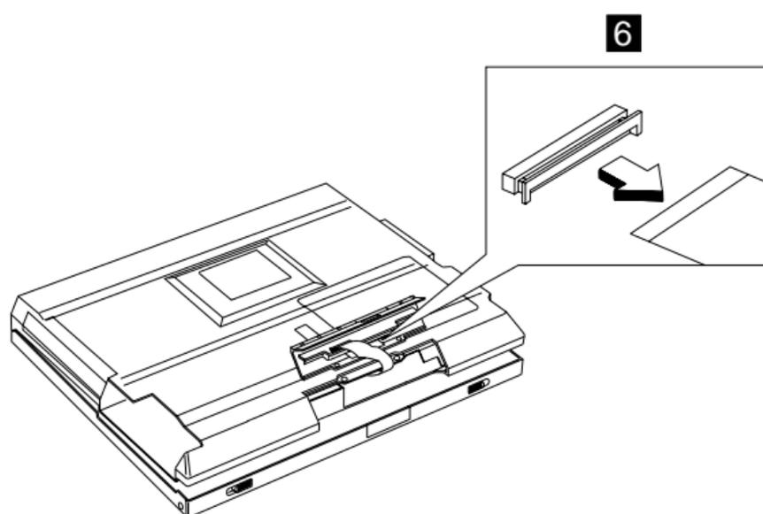
注: FPC は、もう一方の端がシステム・ボードに接続されています。CD プレーヤー・パネルおよび CD プレーヤー・コントロール・ボードを取り外すときは、FPC を注意しながらリリースしてください。
