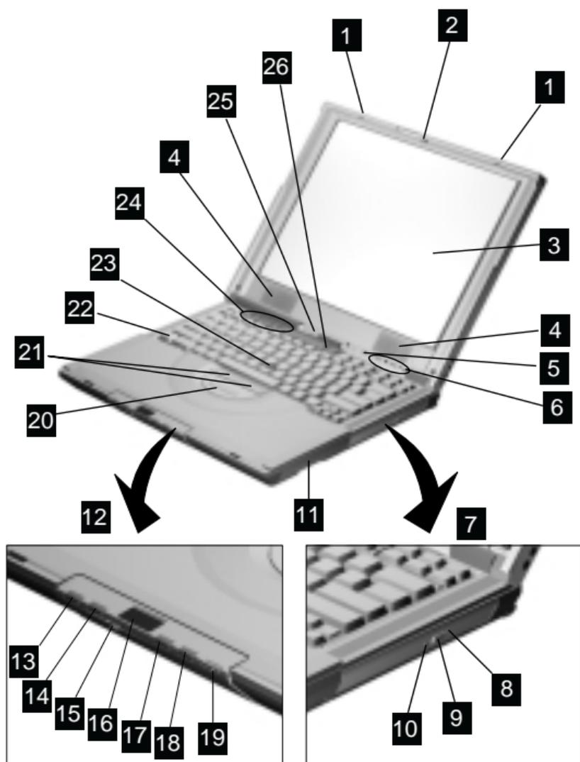
注: 15" LCD では、スピーカー、マイクロホン、および状況インディケータの位置が異なっています。スピーカーは、LCDの背面にあります。マイクロホンおよび状況インディケータは、メイン・ユニットにあります。
