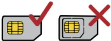
按照图示方向将有切角的一侧朝左上方，将用户识别卡放在入口处，然后滑入卡槽。
