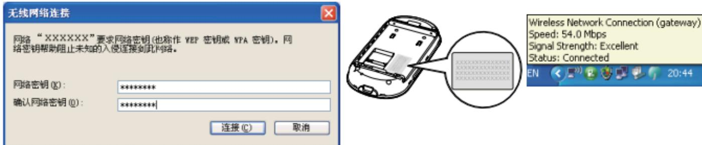
等待片刻，计算机屏幕右下角会显示无线网络连接的图标。此时，无线网络连接成功。
