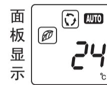
开机后，设置好工作状态。按下遥控器健康键，遥控器和控制盘分别显示“**■**”和“**■**”，同时开始负离子功能。再按一下健康键，遥控器和控制盘上“**■**”和“**■**”显示消失，负离子功能取消。
