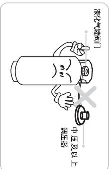
**确保使用正确的调压器（液化气型）**
