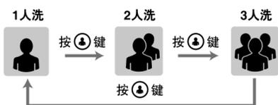
2 机器将根据您选择的洗浴人数自动完成加热。
