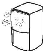
门没关严或频繁开启冰箱门、开门时间过长
