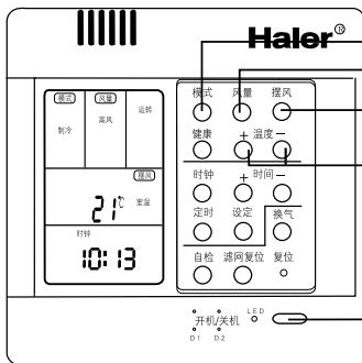
直接按线控器或遥控器开机/关机键
