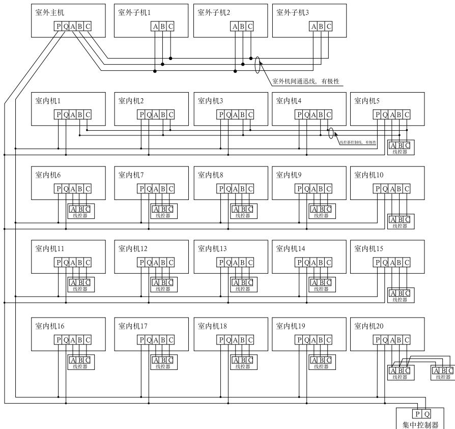
外机间通过3条有极性的线直接并联。主机、集中控制器和所有内机通过2条无极性的线并联在一起。
