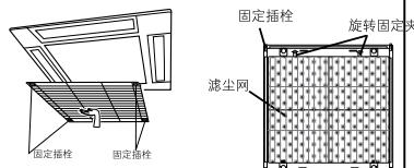
(2) 将进风栅放在内机上，一手拖住，一手将四个角上的插栓栓紧。
