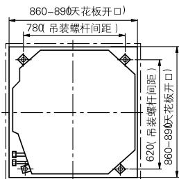
悬挂室内机前，考虑天花板内的配管、配线连接来选定安装场所，并决定配管的引出方向。
