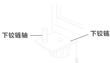
5. 将冷冻门左上方孔插入中铰链的下轴，然后固定好下铰链；
