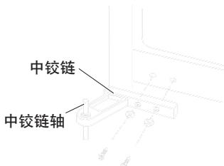
4. 将冷藏门体从左侧安装到箱体上，将中铰链固定到左侧相应的位置上；
