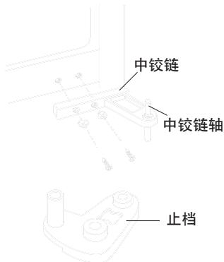
3. 将右上铰链轴拆下，安装到左边相应的位置上；将箱体中梁处左侧的螺钉塞和冷冻门体左侧的孔塞拆下；将冷藏门体右侧止档安装到冷冻门体左侧，将冷冻门体右侧止档安装到冷藏门体左侧相应位置上；
