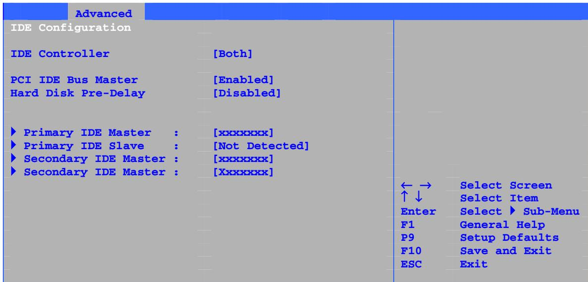
El submenú que aparece en la Tabla 18 se utiliza para configurar las opciones de dispositivo IDE.
