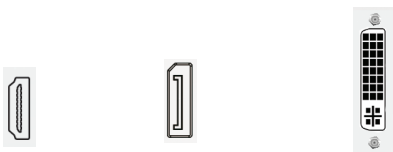
HDMI螢幕輸出接頭 DisplayPort螢幕輸出接頭 DVI-I數位輸出接頭
