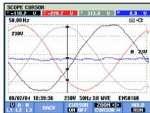
图 17-3. 波形显示（光标和缩放功能启用）
