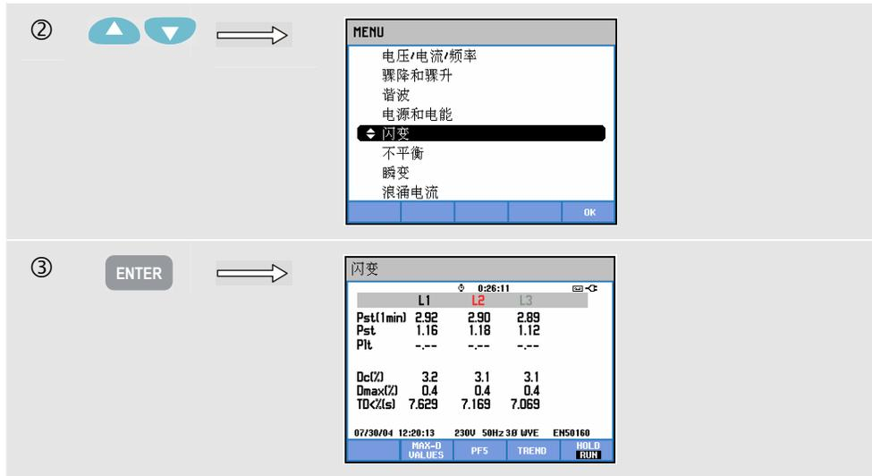
闪变的特征包括：短期严重性 Pst（在 1 分钟时间内测得，用于快速反馈）、短期严重性 Pst（在 10 分钟时间内测得）及长期严重性 Plt（在 2 个小时时间内测量）。该数据以及相关的 D 参数 Dc、Dmax 和 TD（依照 EN61000-3-3）均在表格中显示。
