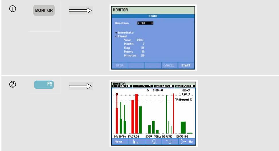
电力质量监测（Power Quality Monitoring）可通过监测（MONITOR）键使用，及通过菜单来设置立即（Immediate）或定时（Timed）启动。利用左/右箭头键，您可以将光标（Cursor）定位在某个条形图（Bar Graph）上。与该条相关的测量数据被显示在屏幕的表头部位。
