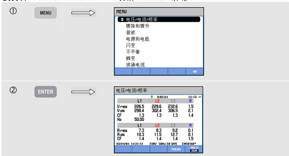
表格概括列出了所有相位上的电压和电流。频率和波形因数也在表格中显示。波形因数 (CF) 表示失真的程度：波形因数 1 表示没失真；高于 1.8 表示高度失真。在用其它测量模式详细检查系统前，可利用该屏幕初步了解电力系统的性能。表格中的列数取决于电力系统的配置。
