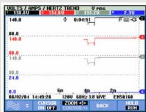
按功能键 F5 三次返回采用新的偏移和跨距设置的 Volts/Amps/Hertz 趋势图屏幕。现在趋势图位于它们的窗口之内。
