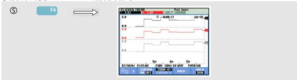
表格中的参数随时间更新。无论何时，当测量启动时，它们就被记录下来。趋势图显示这些值相对于时间的变化。表格中的所有数值均被记录下来，但表格中每一行的趋势图（Trend）每次只能显示一个。按功能键 F1 来将箭头键分配给行选择。趋势图显示画面可由 6 个屏幕组成。
