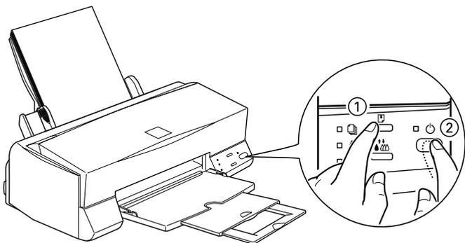
打印机打印出自检样张，其中包括：喷嘴检查图案。下面是输出样本：
