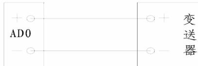
6、信号为 0-20mA 的变送器与 PLC 的模拟量输入口的接线图:
