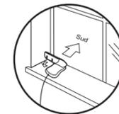
Placer l'antenne sur une fenêtre ou un mur extérieur pour qu'elle soit orientée vers le sud ou sud-ouest par rapport à votre position.
