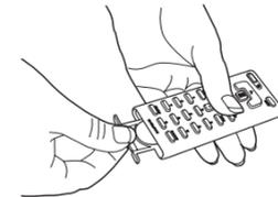
N'oubliez pas de retirer la languette en plastique clair du compartiment à pile avant d'utiliser la télécommande.
