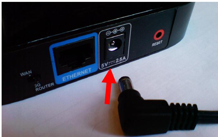
3. 接著將連結至 ADSL/Cable Modem(或現有網路)的網路線接上藍色 Ethernet 連接埠上即可。
