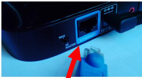
當您依照上述的“硬體連線方式說明”將線路連接完成之後，您的現行網路架構應該會變成如下圖所示的，DIR-412 USB 介面已插上 USB 3G 網路卡，有線端電腦的網路卡連接埠與 DIR-412 的 Ethernet 連接埠 對接，無線端的電腦則經過接在電腦上的無線網路卡與 DIR-412 無線連結。
