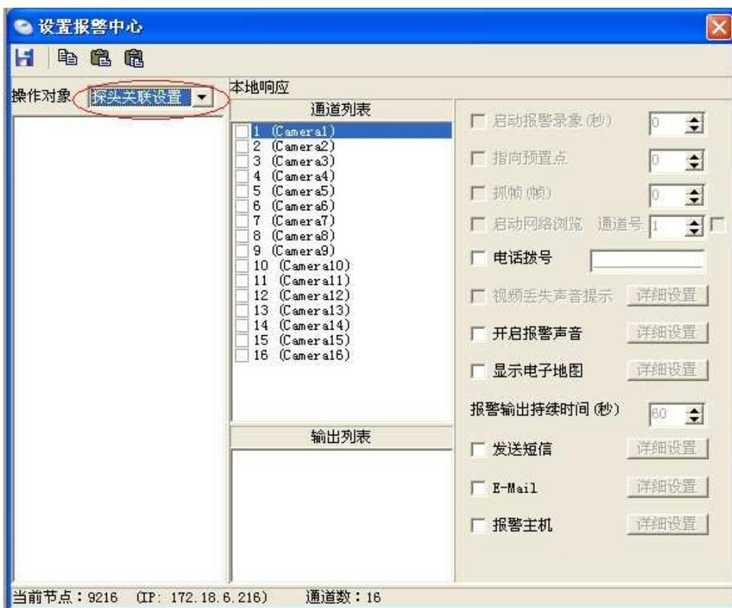
3. 选择探头列表中任意一探头，在本地响应的通道列表中选择此探头相关联的通道（一个探头可以关联多个通道）。
