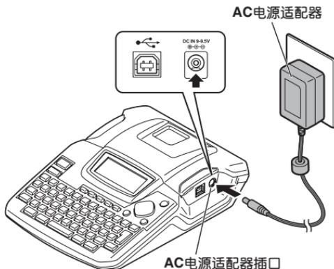
**1** 将 AC 电源适配器的连接插头牢固地插到本机的 AC 电源适配器插口上。
