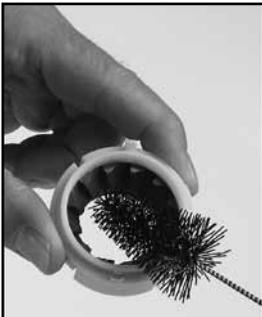
Verwenden Sie die Borstenbürste (mitgeliefert) zur Entfernung loser Kaffeereste vom Ringmahlwerk und vom Kegelmahlwerk, das sich im Motorengehäuse befindet. Waschen Sie die Silikon-Dichtung in warmem Seifenwasser und lassen Sie sie trocknen.
