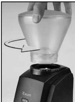
Schalten Sie die Mühle ab und ziehen Sie den Netzstecker. Entfernen Sie etwaige restliche Bohnen vom Bohnenbehälter. (Dies geht am einfachsten, indem Sie die Mühle umkippen und die Bohnen in einer Schale ausschütten). Entfernen Sie den Behälter, indem Sie ihn soweit wie möglich nach links drehen und ihn dann vom Gehäuse abheben. Waschen Sie den Bohnenbehälter, den Deckel und den Mahlgutbehälter mit warmem Seifenwasser, spülen Sie die Teile ab und lassen Sie sie trocknen.
