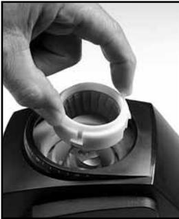
Ziehen Sie die Silikon-Dichtung vom Ringmahlwerk. Entfernen Sie das Ringmahlwerk, indem Sie es aus der Mühle an den Laschen hochheben. Wird das Mahlwerk nicht herausgehoben, stellen Sie sicher dass die Mahlgradeinstellungs-Lasche ist vollständig entgegen dem Uhrzeigersinn gedreht ist.
