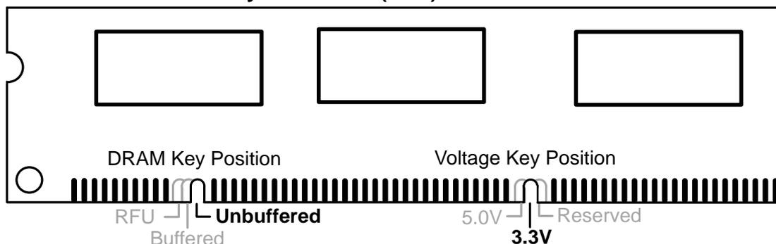
DIMM 記憶體模組尾端凹槽設計的辨識，將關係到記憶體的種類與使用電壓，如果您在購買記憶體之前未經詳細查明，極有可能買到不符合規格的產品。
