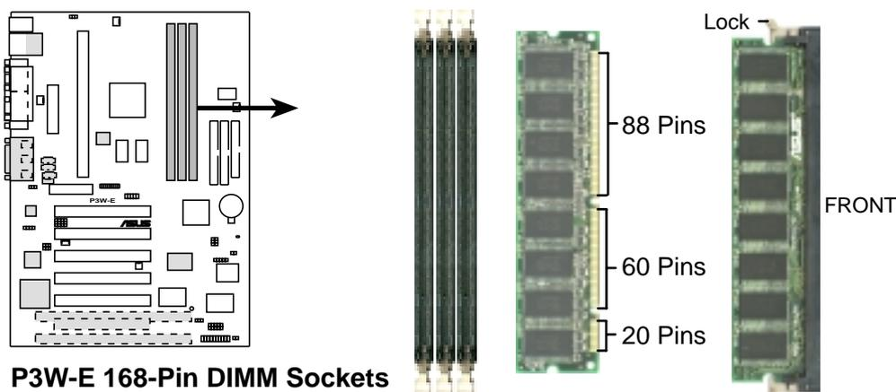
本主機板支援 3.3 伏特 SDRAM，底下的插圖將告訴您如何正確地辨識 3.3 伏特與 5 伏特的 DIMM：
