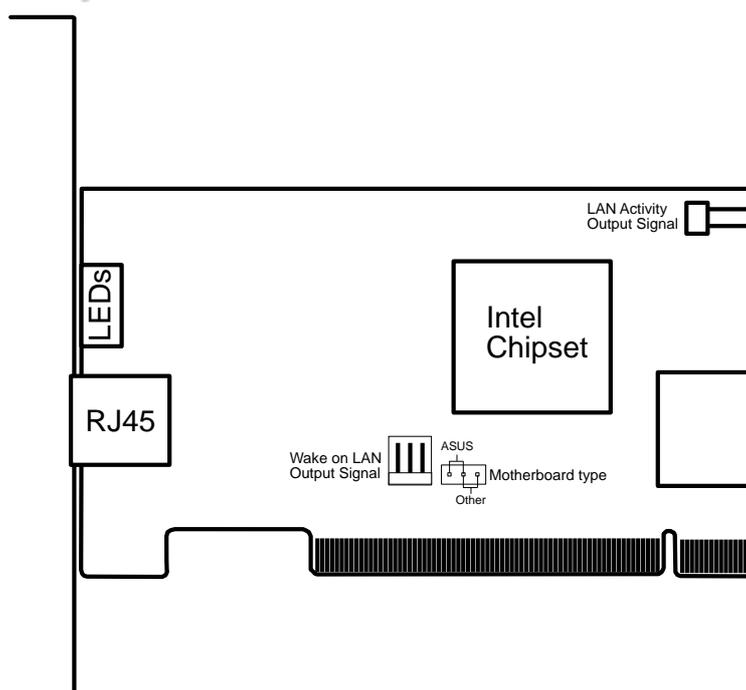
如果您使用華碩主機板與華碩 PCI-L101 網路卡，請將跳線帽設定在 **ASUS**，如果您是在其它廠牌主機板上使用 PCI-L101 網路卡，請將跳線帽設定在 **Other**。網路卡上的 Wake on LAN (WOL) 接針是讓您連接到主機板上的 WOL\_CON 接針，使系統可以享有網路喚醒功能。而卡上另一個 LAN\_LED 接針，則請連接到主機板上面板上的 LAN\_LED 接針，如此一來，當主機外殼的燈號閃爍時，就是表示網路卡正處於運作狀態。
