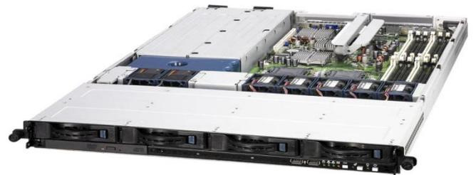
4 个 SAS 硬盘扩展（可兼容 SATA 硬盘），提供完整的 RAID 解决方案，支持低成本的 RAID 0, 1, 1E 等功能，可以选购 ZCR 升级至硬件 RAID 5，有效保护您的宝贵数据。
