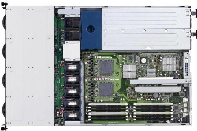
华硕创新的无线材内部设计，不仅简洁美观，更能消除紧密机箱中线路对气流和信号的影响，确保更高的散热效率和优质的传输信号。
