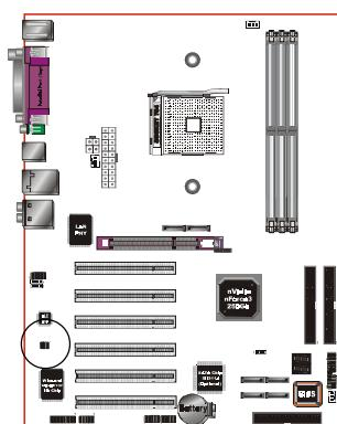
**SPDIF:** SPDIF 音频数字输出接口(Sony/Philips Digital Interface)
