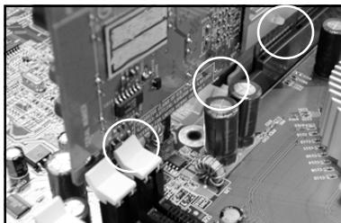
1. AGP卡零件被DIMM socket卡到。
