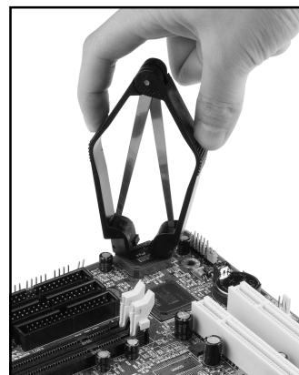
任何有意或以错误方式更换BIOS是被禁止的，否则，将可能导致BIOS插座损坏使系统无法开机。
