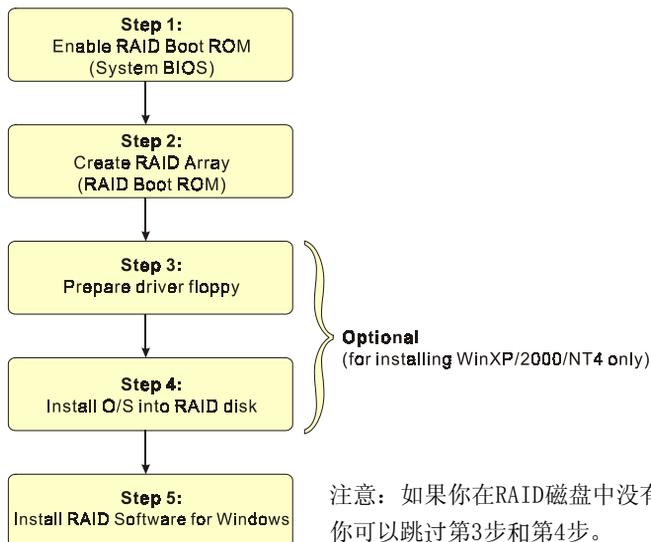
注意: 如果你在RAID磁盘中没有安装O/S, 你可以跳过第3步和第4步。
