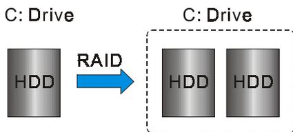
单独的磁盘设备在RAID阵列中叫“成员”，对操作系统来说所有磁盘成员都被视做一个物理的整体。硬盘设备能经过一个特殊的方法整合在一起，不同的方法涉及到不同的RAID方法，不同的RAID标准又表现出不同的性能标准，安全标准及执行价值。
