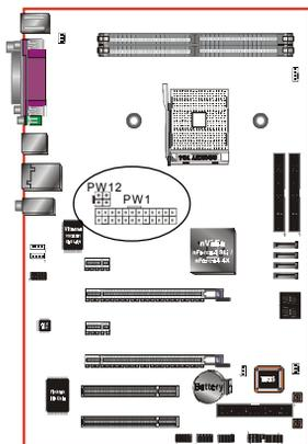
**PW1:** 24脚位ATX 电源接口
