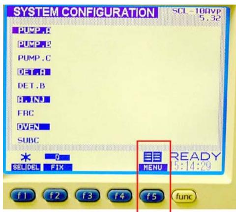
**Figura 20** Finestra di avvio del controllore di sistema
