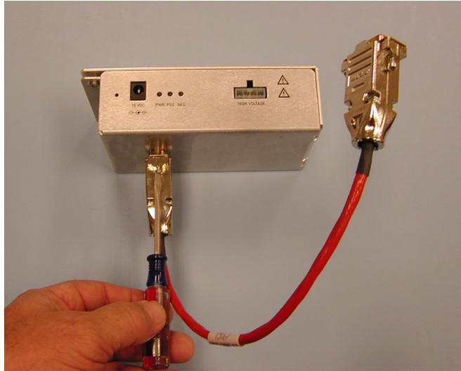
**Abbildung 22** Anschließen des RS-232-Kabels
