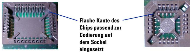
**Abbildung 1** Sockel mit Codierung für Chips U6 und U18 auf der Stromverteilerplatine (links) und Sockel mit Codierung für Chip U129 auf der Analyzer 3-Platine (rechts). Beachten Sie, dass sich die Codierung in der oberen linken Ecke der Analyzer- und in der oberen rechten Ecke der Stromverteilerplatine befindet.
