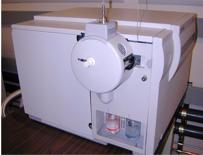
**Abbildung 32** Multimode-Ionenquelle mit angebrachten Abdeckungen
