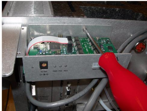
**Figura 17** Sujetar la fuente de alimentación de la PCA de control y alta tensión
