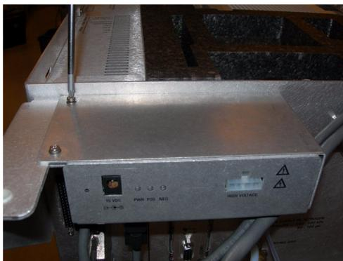
**Figura 18** Sujetar a los soportes de apoyo
