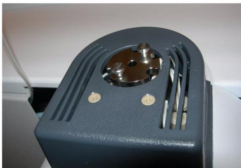
**Figura 10** Sin nebulizador en la parte superior de la fuente multimodo
