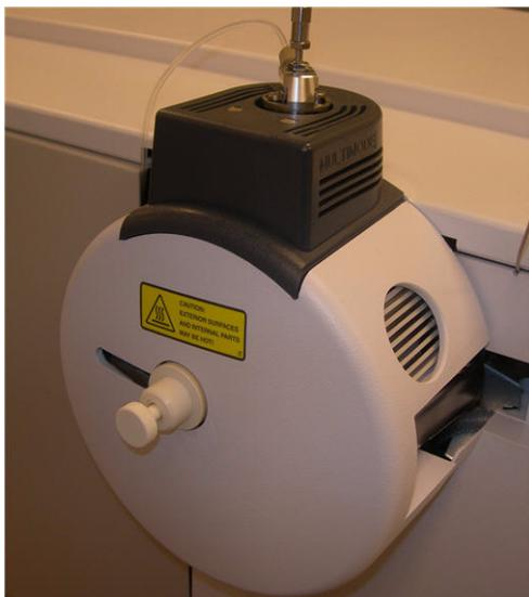
**Figura 24** Instrumento con fuente multimodo instalada
