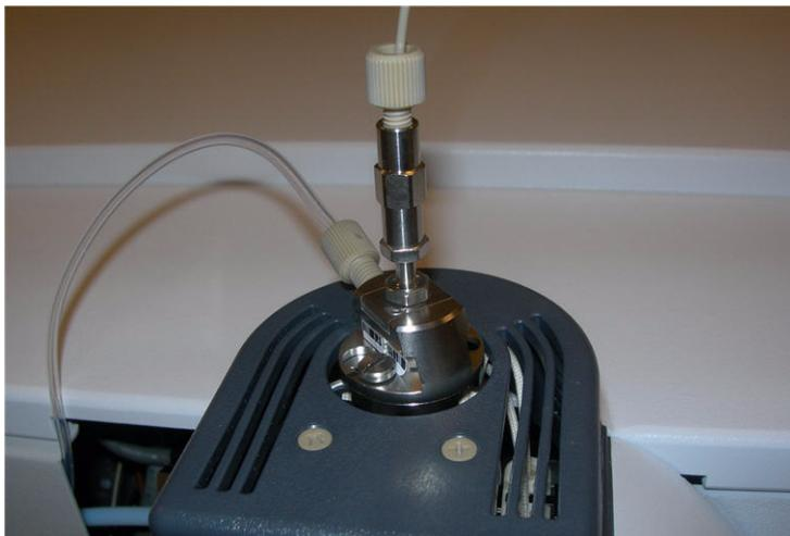
**Figura 11** Nebulizador con tubo de gas conectado
