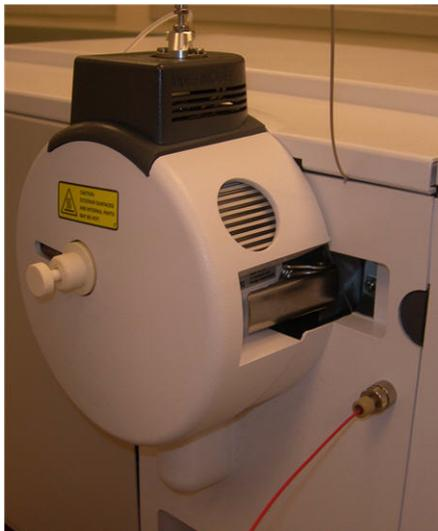
**Figura 12** Tubos de muestra del sistema LC/MS de trampa de iones conectados al filtro de entrada
