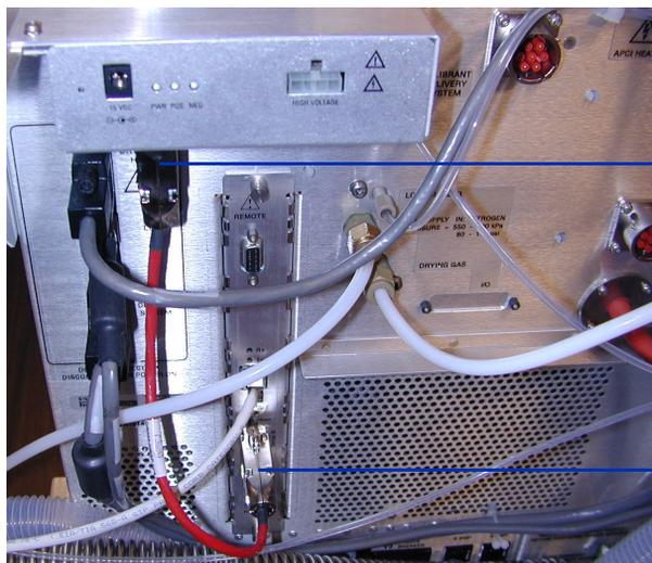
Conexión RS-232 a la PCA de control y alto voltaje
