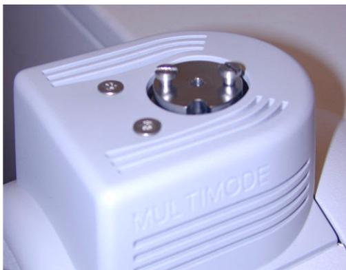
**Figura 18** Sin nebulizador en la parte superior de la fuente multimodo
