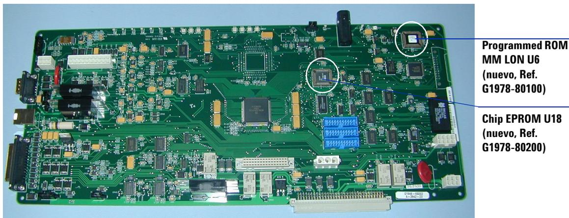
**Figura 7** Se deben sustituir dos chips en la placa de distribución de alimentación (Ref. G1946-65002)
