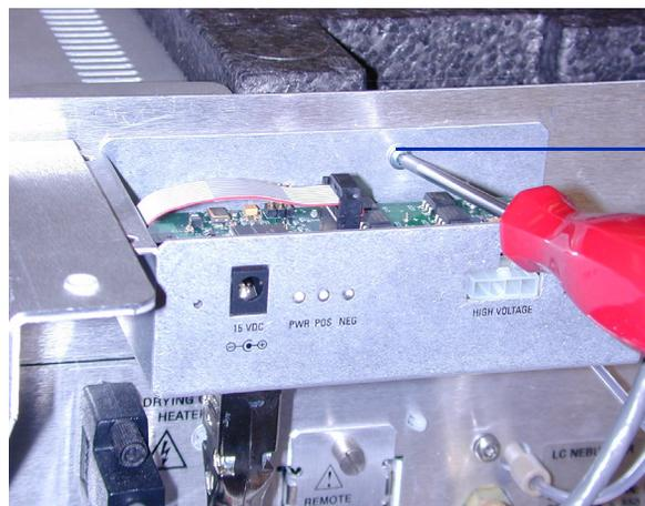
Sujete la fuente de alimentación de la PCA de control y alta tensión a la estructura
