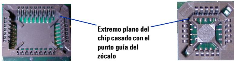
**Figura 1** El zócalo con el punto guía para los chips U6 y U18 en la placa de distribución de alimentación (izquierda) y el zócalo con el punto guía para el chip U126 en la placa Analyzer 3 (derecha). Observe que el punto guía se sitúa en la esquina superior izquierda de la placa Analyzer y en la parte contraria (superior derecha) en la placa de distribución de alimentación
