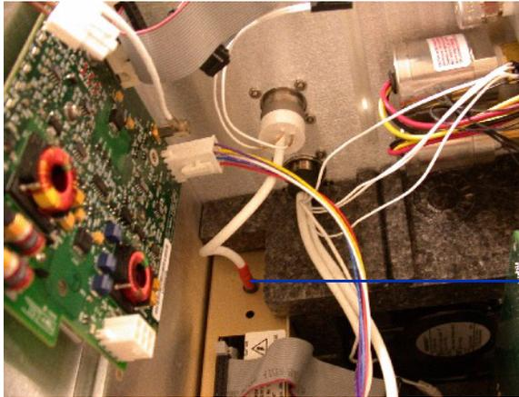
Desconecte aquí el cable de alto voltaje del APCI.
