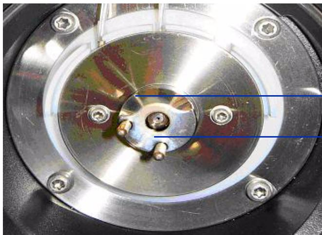
Electrodo del spray shield en posición de 9 en punto
