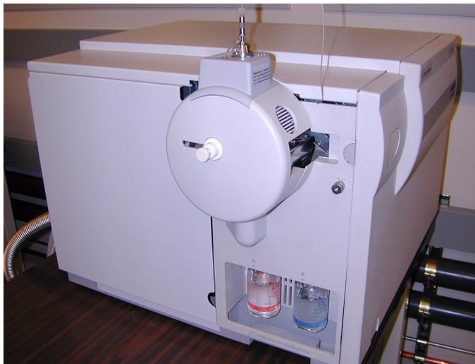
**Figura 32** Fuente multimodo con tapas colocadas
