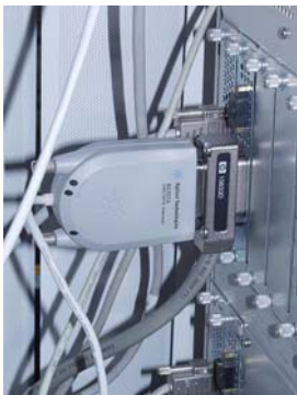
Figura 6 Conexión de la interfase USB-GPIB
